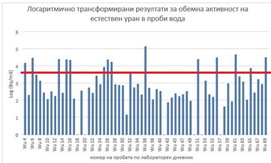
Фигура 106. Съдържание на уран в изследваните през 2020 г. води от района на бивши уранодобивни обекти
