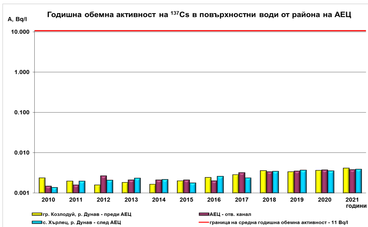
Фигура 92. Средно годишно съдържание на цезий-137 в повърхностни води от района на АЕЦ за периода 2010-2021 г. (логаритмична скала)
